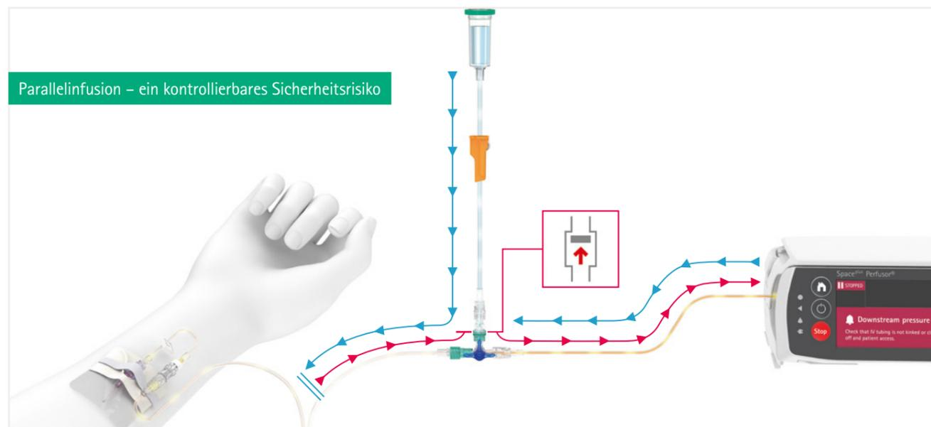
Ein Rückschlagventil vermeidet den Rückfluss von Infusionslösungen bei Parallelinfusionen und ist damit eine effektive technische Vorkehrung, um die Sicherheit komplexer Infusionssysteme zu erhöhen.
