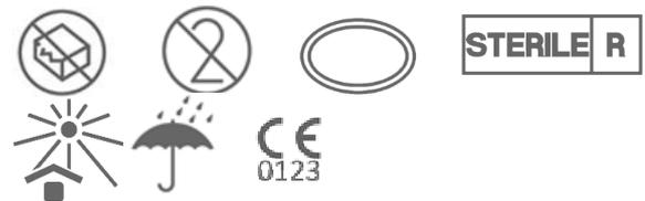
Kennzeichnung auf allen Verpackungsstufen mit CE und nach DIN EN ISO 15223-1 und DIN EN ISO 20417.
